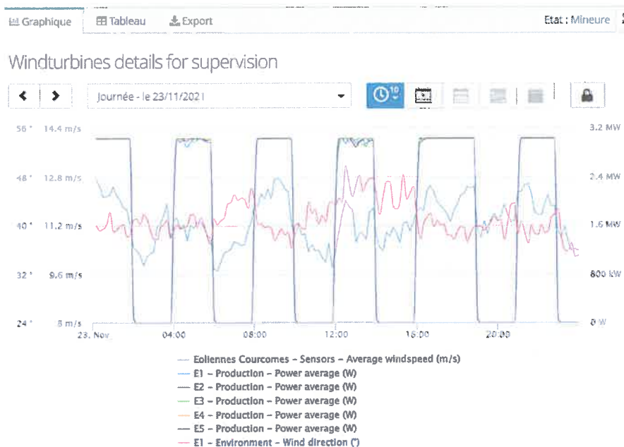
Figure n°14 – Arrêts réguliers du parc de Courcôme le 23 novembre 2021 afin de pouvoir comparer les niveaux sonores avec et sans le parc éolien. Cette journée a notamment permis de caractériser des vents Nord-Est entre 9 et 13 m/s à hauteur de moyeu.
